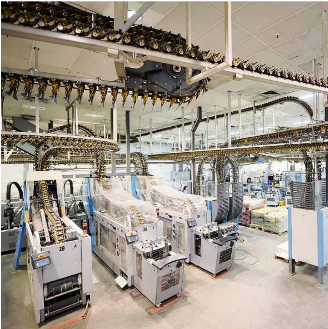
Mit den neun Ferag MultiSertDrum-Linien im Druckzentrum Hagen lassen sich Vorprodukte und Werbebeilagen gezielt in das Hauptprodukt einstecken und ermöglichen das Kombinieren von redaktionellen Inhalten und Werbebotschaften.
