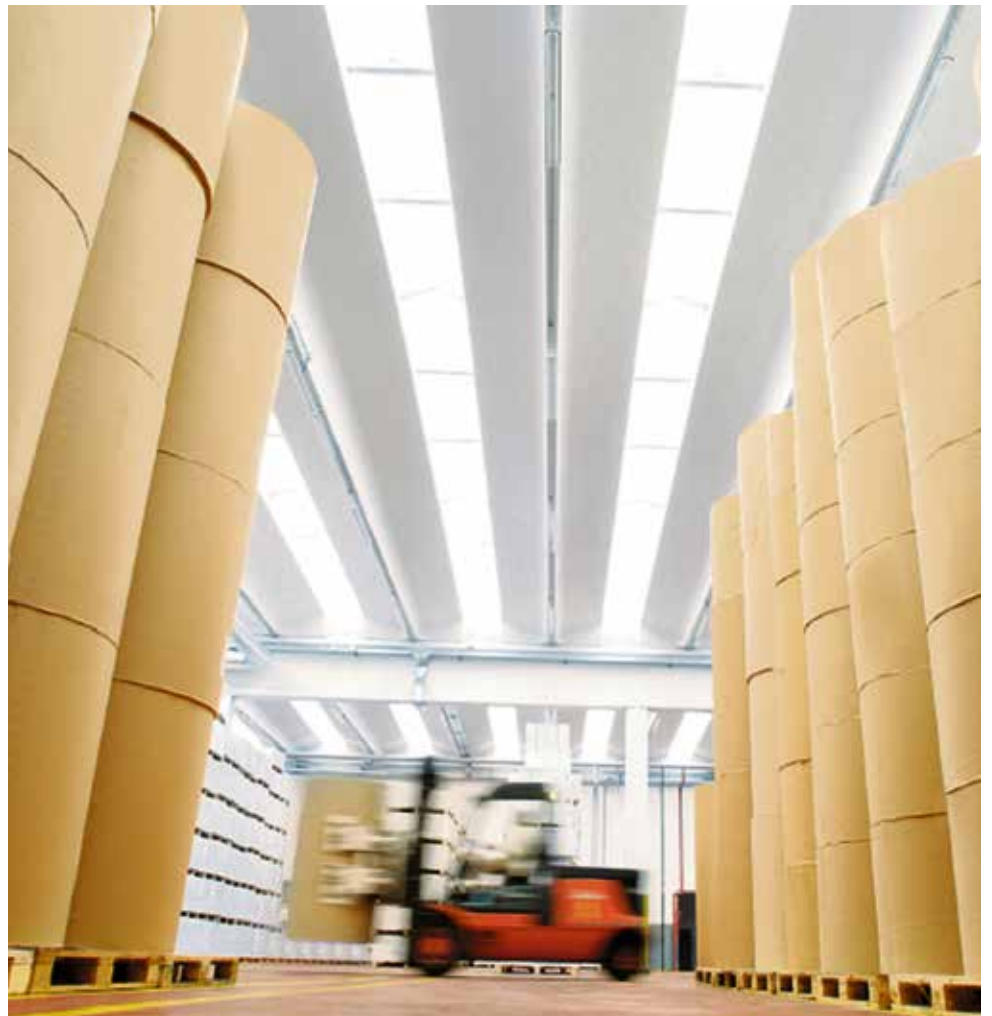
Zu hohen Türmen gestapelt liegen die großen Zeitungspapierrollen in den Lagern des Druckzentrums Essen. Mit Gabelstaplern werden die Rollen direkt zu den Rotationsmaschinen gefahren. Etliche Tonnen Papier werden so jeden Tag von A nach B transportiert und sorgen dafür, dass die Maschinen nicht stillstehen.
